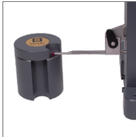
Калибровка шарика измерительной вставки
